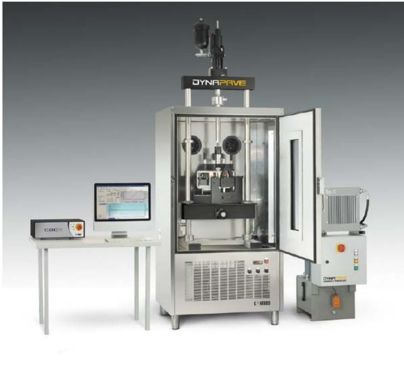
Visione d'insieme della macchina DYNAPAVE 30 per prove su conglomerati bituminosi ad Alto Modulo e speciali
