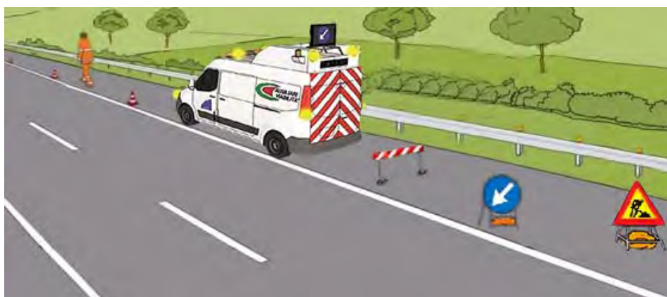
Figura 14 – Fermata del veicolo con corsia di emergenza chiusa
