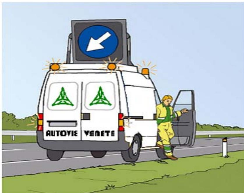
Dopo aver consentito l'uscita degli addetti dal lato destro, il conducente, prima di scendere, deve posizionare l'automezzo sull'estremo margine destro della corsia di emergenza. A mezzo fermo sarà cura dell'operatore innestare il freno a mano, girare le ruote in direzione opposta al lato traffico e innestare la marcia.
