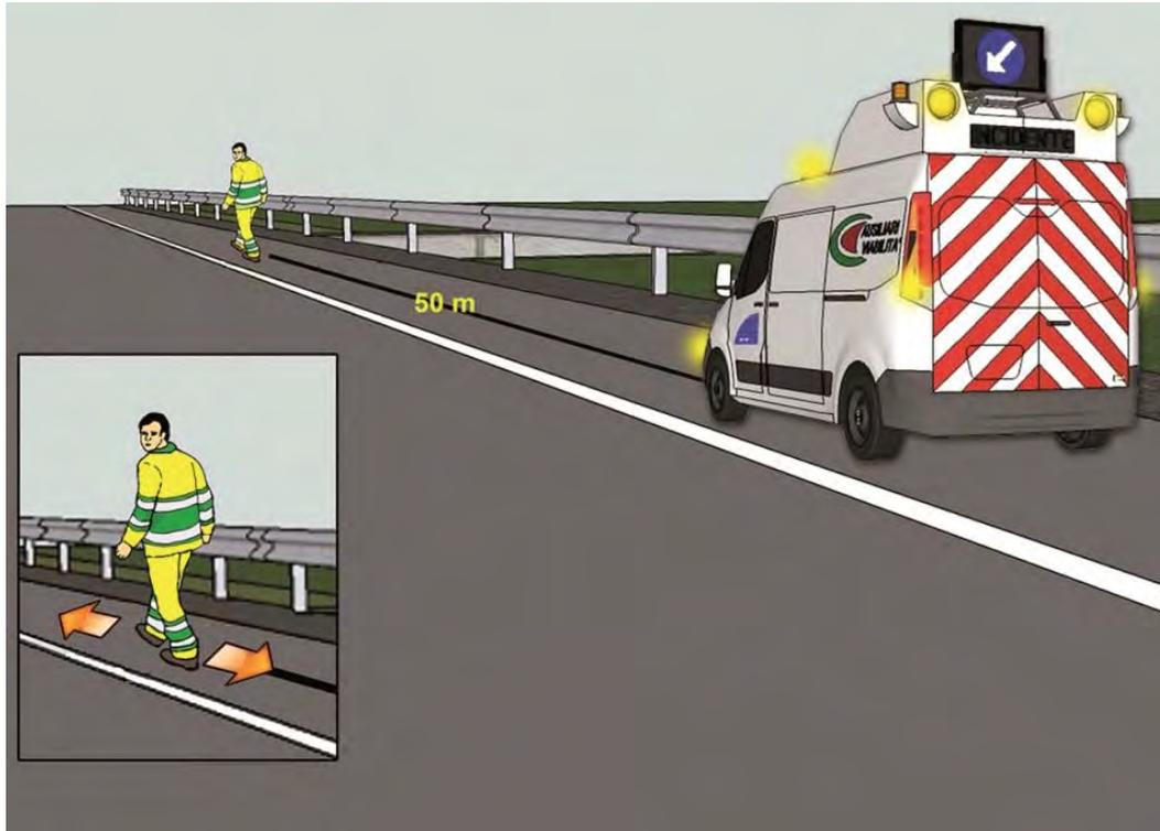
*Figura 11 – Spostamento a piedi lungo la corsia d'emergenza*
