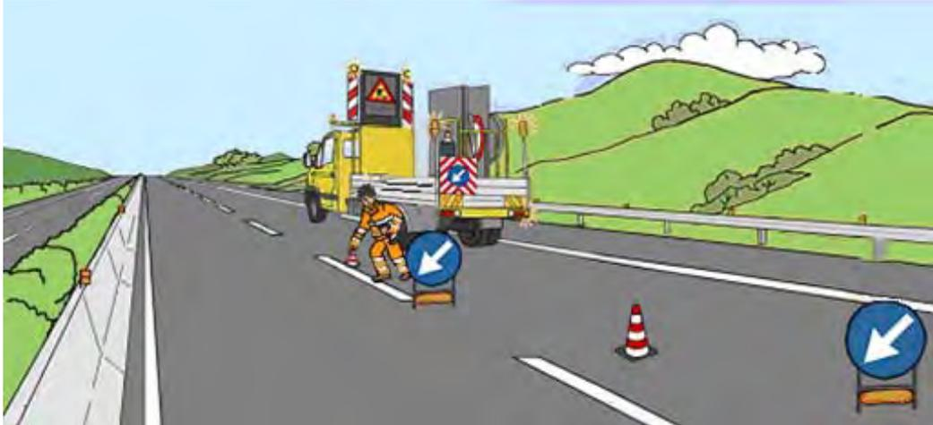
*Figura 26 – Chiusura della corsia di marcia: inizio della posa dei coni*
