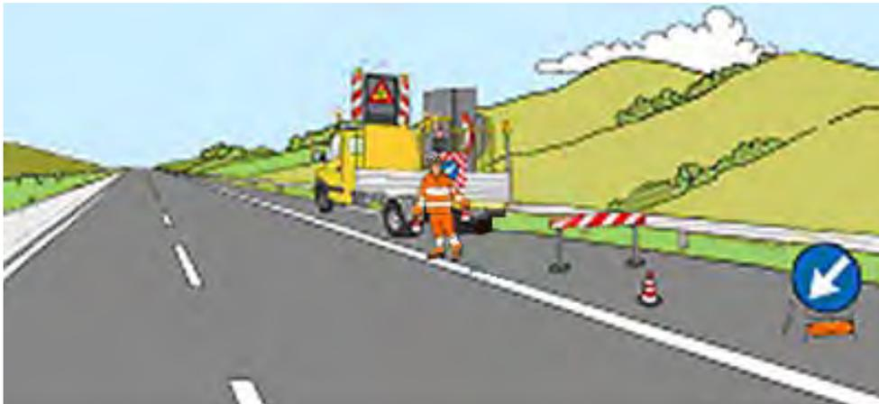
*Figura 19 – Chiusura della corsia di emergenza: installazione della testata di chiusura*
