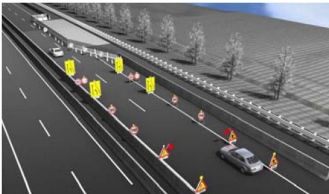
Esempio di layout di segnaletica di cantiere
