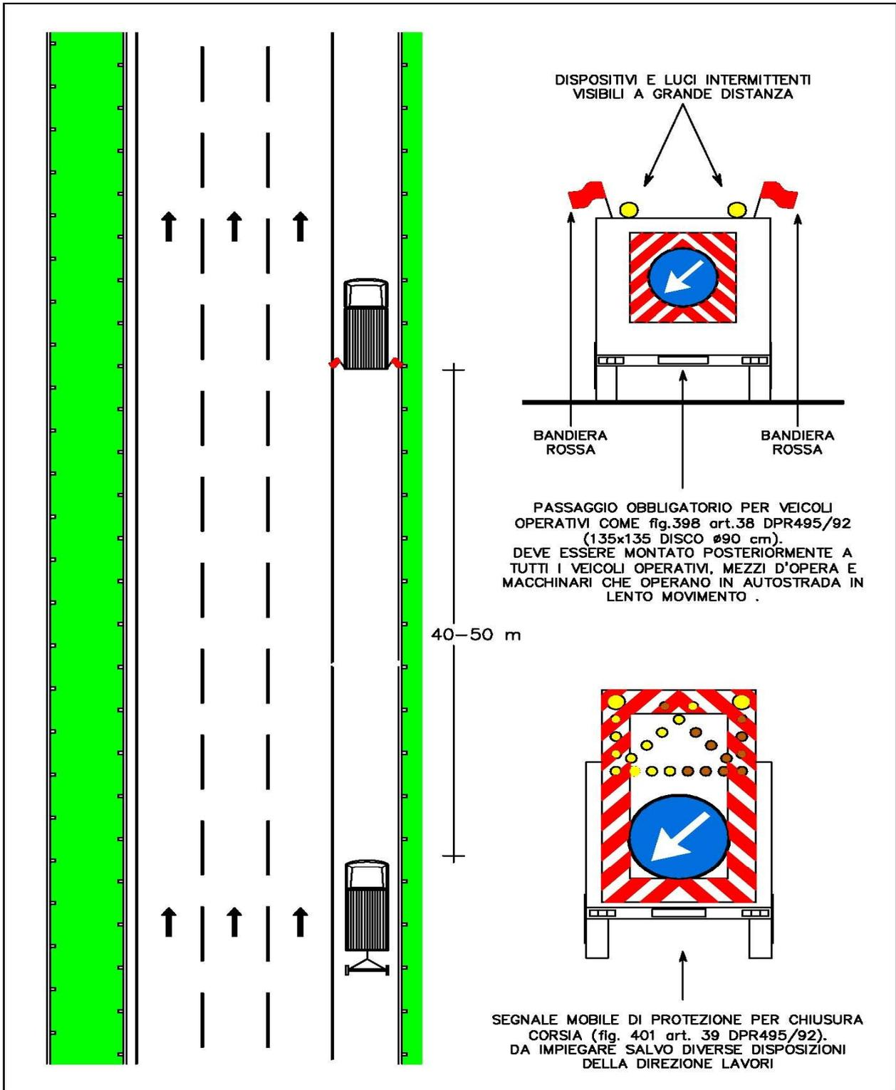
**CANTIERE MOBILE CON CHIUSURA DELLA CORSIA DI MARCIA, PER LAVORI, CONTROLLI, SONDAGGI E VERIFICHE DI RAPIDA ESECUZIONE IN TANGENZIALE CON 2 CORSIE SENZA CORSIA DI EMERGENZA**
