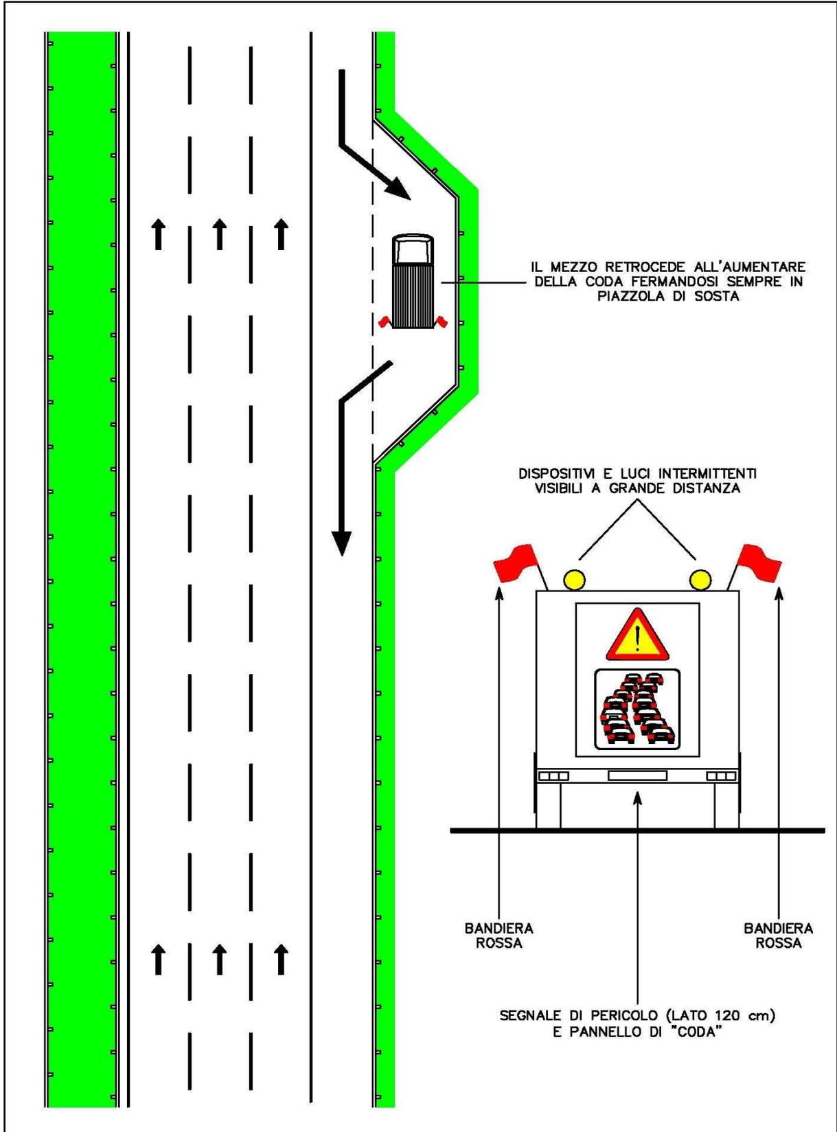
**MEZZI DI LAVORO IN MOVIMENTO LENTO SULLA CORSIA DI EMERGENZA, PER LAVORI, CONTROLLI, SONDAGGI E VERIFICHE DI RAPIDA ESECUZIONE IN AUTOSTRADA CON 2 O 3 CORSIE O TANGENZIALI CON CORSIA DI EMERGENZA**
