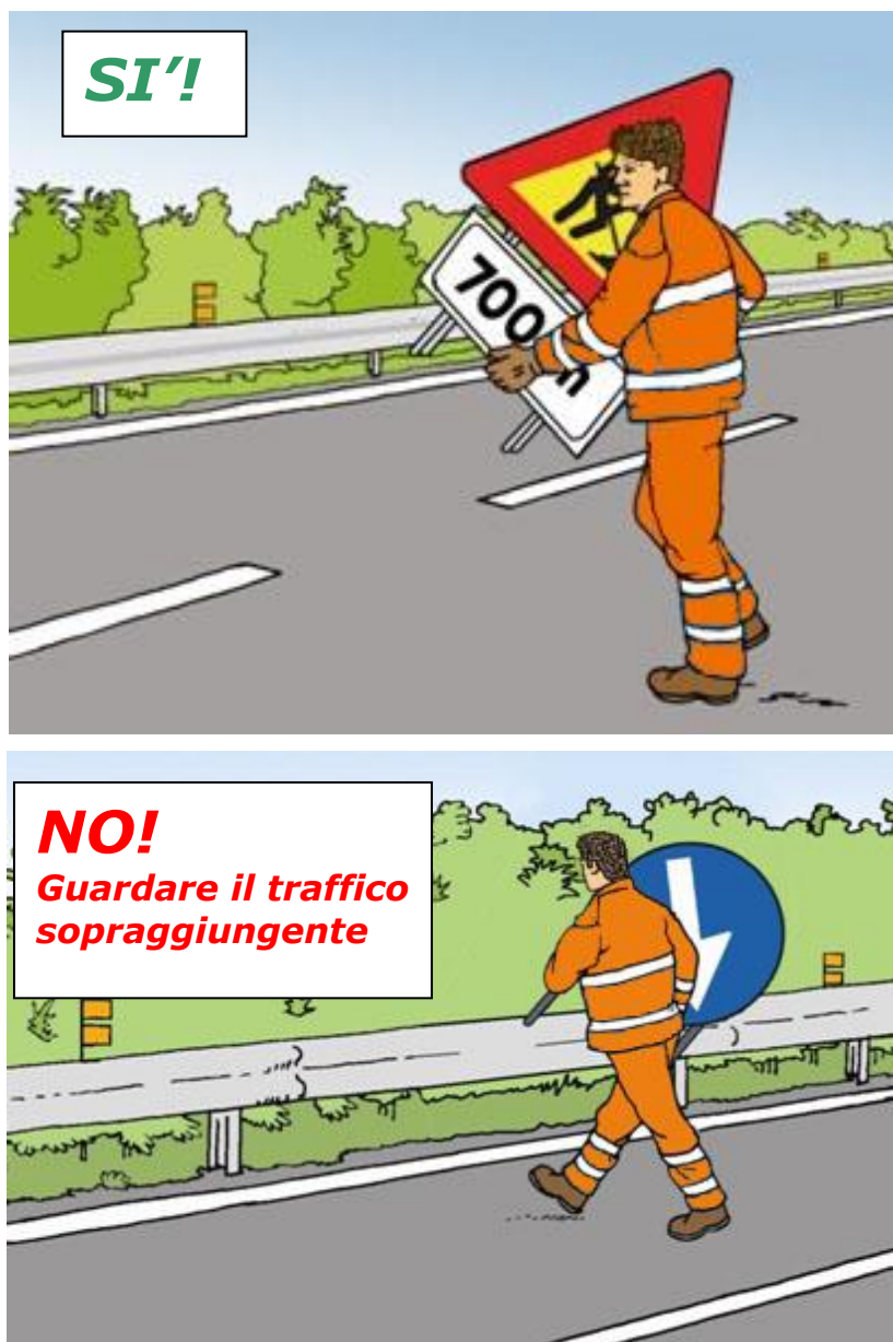
Figura 17 – Trasporto manuale della segnaletica di dimensioni “normali o piccole”
