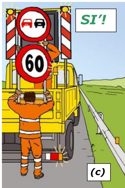
Figura 16 – Prelevamento della segnaletica da automezzo: comportamenti corretti (a), (c) e scorretti (b), (d)
